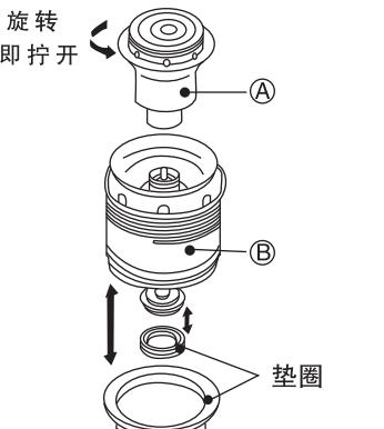
※中栓垫圈安装时有方向性，请注意确保正确安装。如安装错误，会出现内容物漏出、保温或保冷效果降低等现象。
