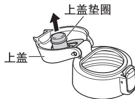
捏住上盖垫圈的前端，转动着缓慢拆卸。 注意上盖垫圈的安装方向，镶嵌到底。
