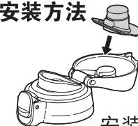
安装上盖垫圈的时候不可弄错方向，请确实地嵌进深处。
