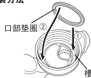
安装时, 请确实将垫圈嵌入
