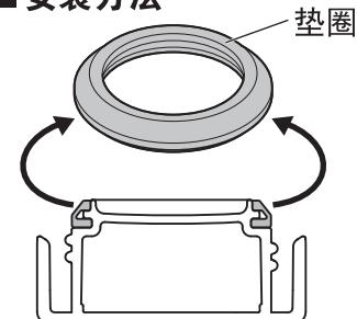
确认垫圈的安装方向，
