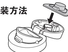
注意上盖垫圈的安装方向，
