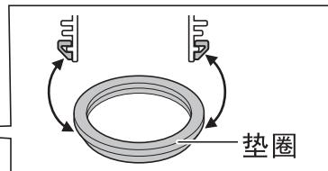
拆卸时，抓住垫圈的边缘慢慢取下。
