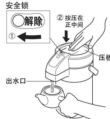
6 倒完水后，安全锁必须返回"锁定"状态。
