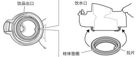
上盖垫圈的拆卸、安装方法
